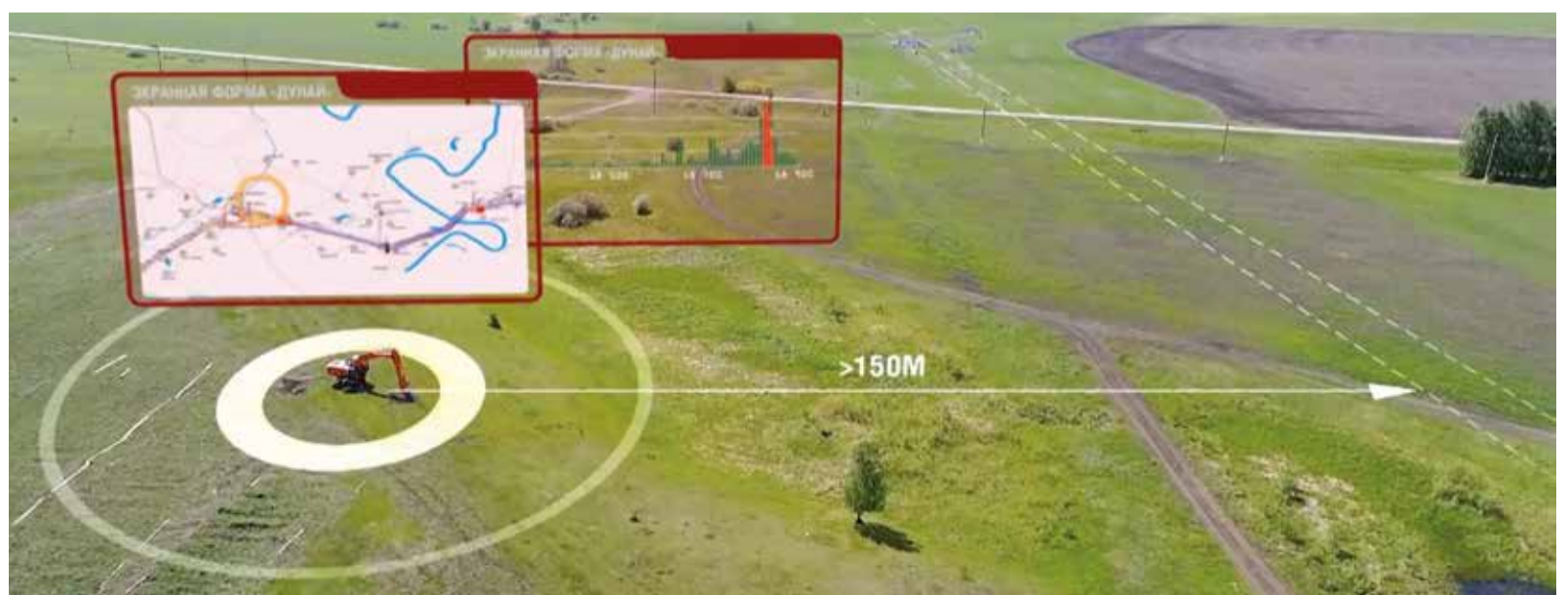
Система лазерного обнаружения утечек метана
