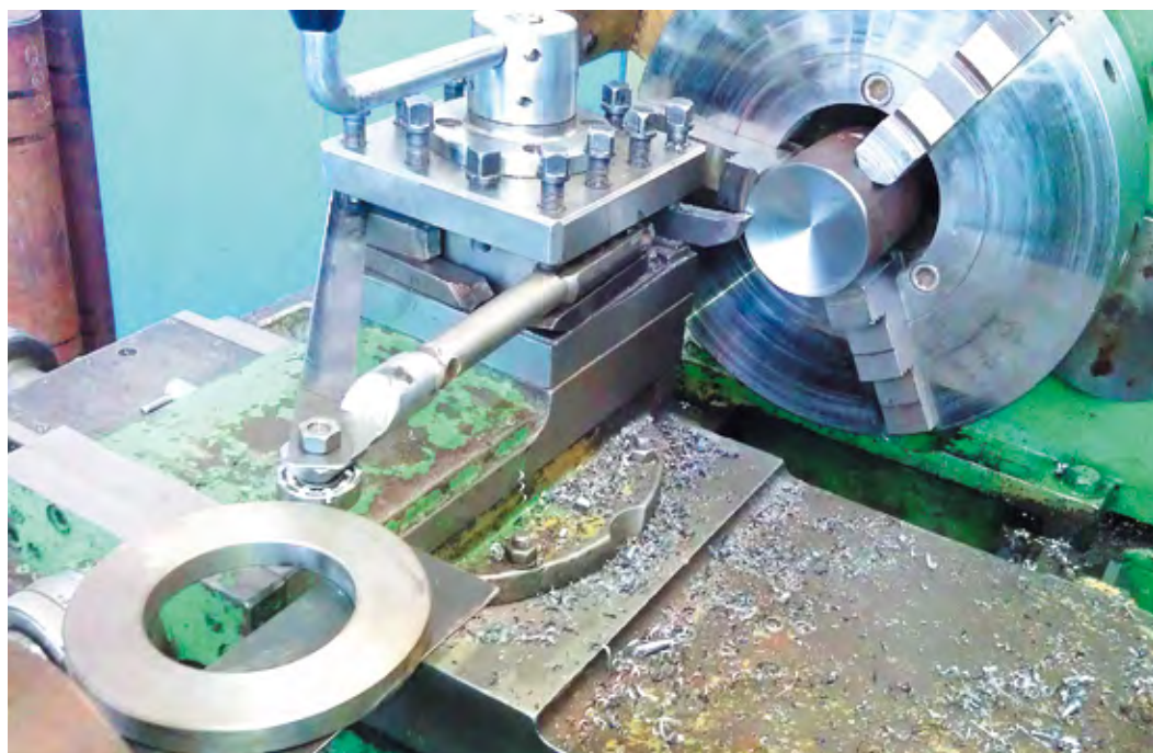
Приспособление для изготовления сферических поверхностей, разработанное Алексеем Ефтоновым (УАВР)
